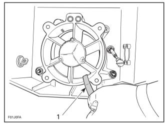
TYPICAL — MEASURING FROM VENTURI SIDE
